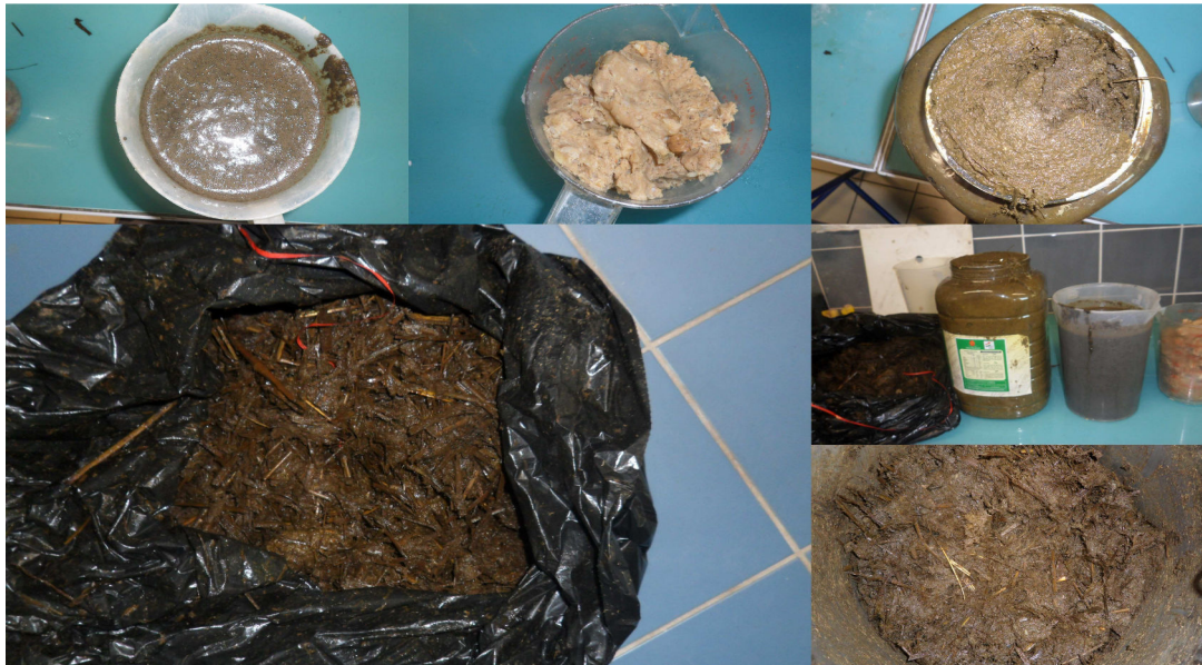
Figure IV-9 : Photo des substrats initiaux utilisés pour la co-méthanisation des déjections animales associées aux restes de repas
