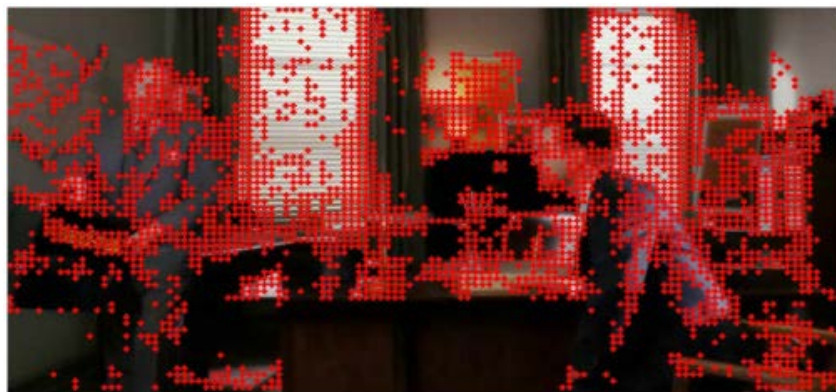
FIGURE 3.7: Visualisation des points denses après l'application du critère de suppression des points appartenant aux régions homogènes [Wang et al., 2011a].
