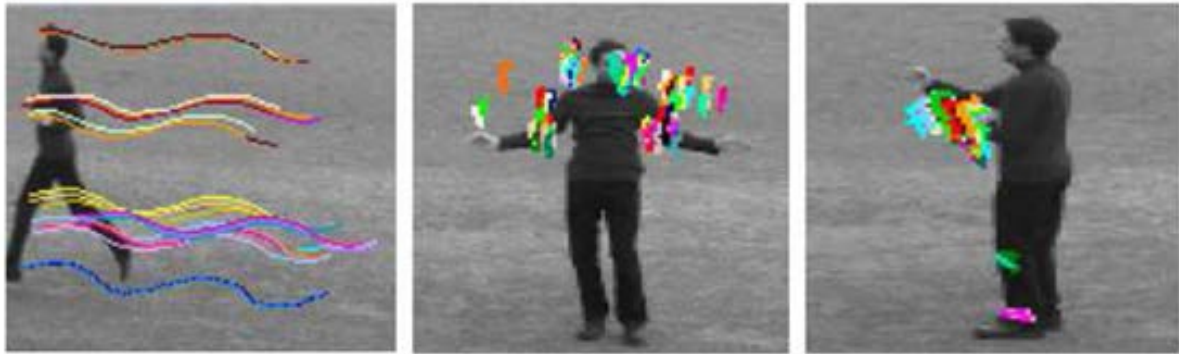
FIGURE 3.10: Exemple des trajectoires des Harris-3D obtenues par l'application de l'algorithme KLT.
