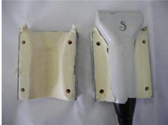
**Figure 33 : Photographie du moulage de sonde en polyuréthane**
