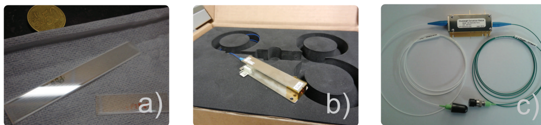
FIGURE 2.1 – Photographies des trois types de PPLN : a) PPLN Paderborn ; b) PPLN HCP ; c) PPLN NTT.
