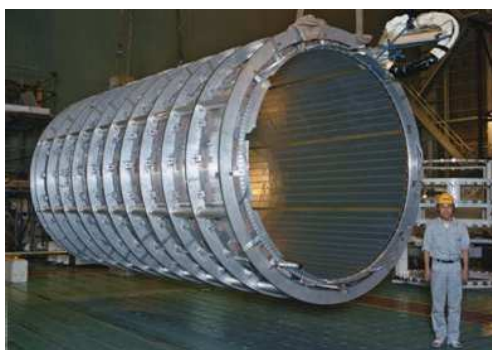
FIGURE 2.23 – Photographie du cryostat permettant de maintenir une basse température au solénoïde et au calorimètre électromagnétique tonneau. Source : [26].
