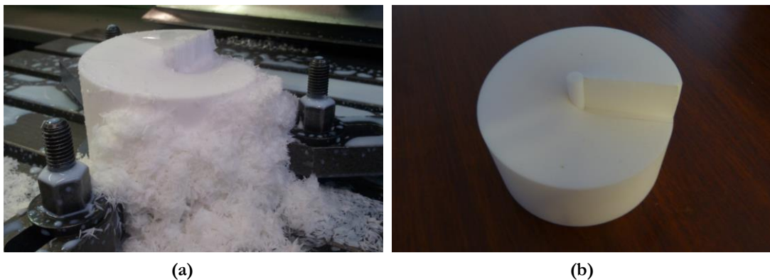
Figure 2.25 : Photographie de la lame de phase spirale en cours de réalisation (a) et réalisée (b).
