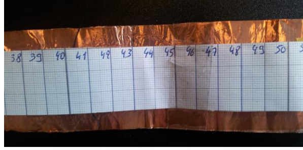
Figure 1.13 : Photographie d'une section de l'anneau de cuivre utilisé comme détecteur.
