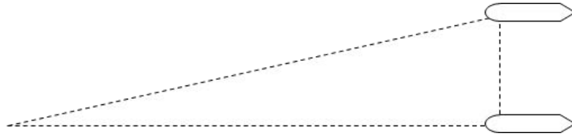
Figure 2.37 : L'antenne d'émission reste fixe lorsque le mât se déplace. Il est donc nécessaire de corriger la contribution du lobe de cette antenne.
