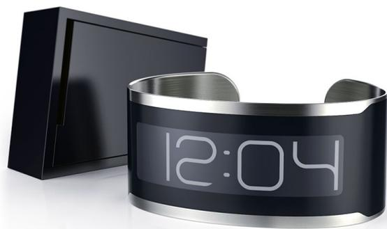
Figure I-9 : Montre CST-01 et son module de "charge/réglages". Cette montre est certifiée étanche et fournie pour une durée de vie de plus de 10 ans sans changement de batterie.
