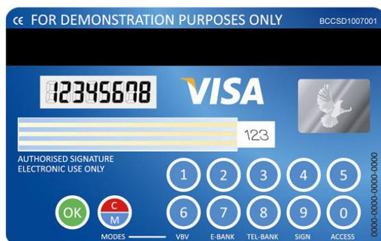
Figure I-7 : Vue d'artiste d'une "SmartCard" VISA. L'écran LCD flexible est situé en haut à gauche. Les commandes digitales sont pour leur part positionnées sur la partie basse de la carte. Le tout étant alimenté par une batterie enfouie dans la carte.
