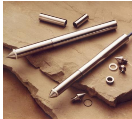
Figure 1-2. Essai de pénétration CPT (à gauche) et détails de pointes de pénétromètre (à droite)
