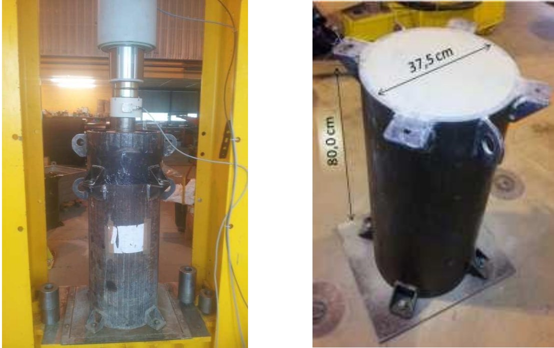
Figure 1-9. Réalisation de l'essai dans le moule de calibration (Llanca-Vargas, 2014).
