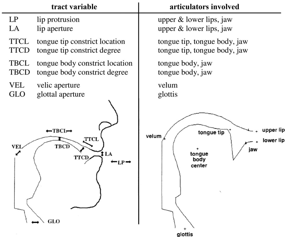
Figure 7 : La Coupe sagittale du conduit vocal en sortie du synthétiseur articulatoire de Haskins Laboratories. Les variables du conduit vocal (positions et degrés des constrictions) y sont montrées de manière schématique. (D'après Browman & Goldstein, 1989).
