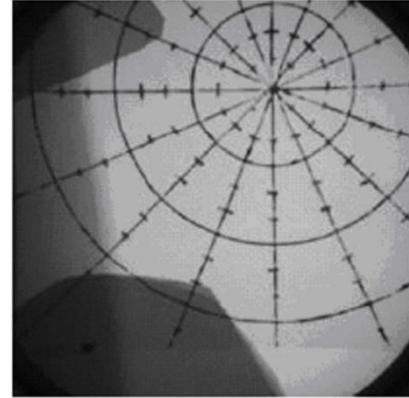
Figure 23 : Exemple d'un plan de travail avec projecteur utilisé pour le traçage manuel des radiogrammes (à gauche), et un exemple d'une grille de référence projetée sur le plan de travail (à droite). (in Vaxelaire *et al.*, 2009).
