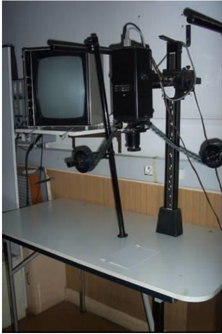
Figure 23 : Exemple d'un plan de travail avec projecteur utilisé pour le traçage manuel des radiogrammes (à gauche), et un exemple d'une grille de référence projetée sur le plan de travail (à droite). (in Vaxelaire et al. , 2009).
