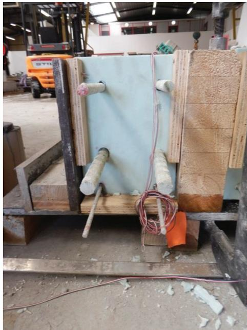
**Figure 7.7** – Position des armatures aux appuis
