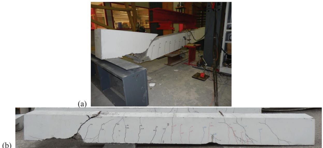
Figure 5.32 – Rupture au tranchant de la poutre ShC-[5d10] (a) en fin d'expérience (b) après l'expérience pendant son stockage
