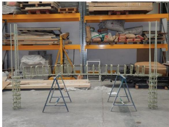
**Figure 7.5** – Préparation des cages d'armatures avant la phase de coulage
