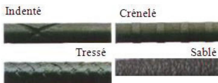
**Figure 2.7** – Différents types de traitement de surface
