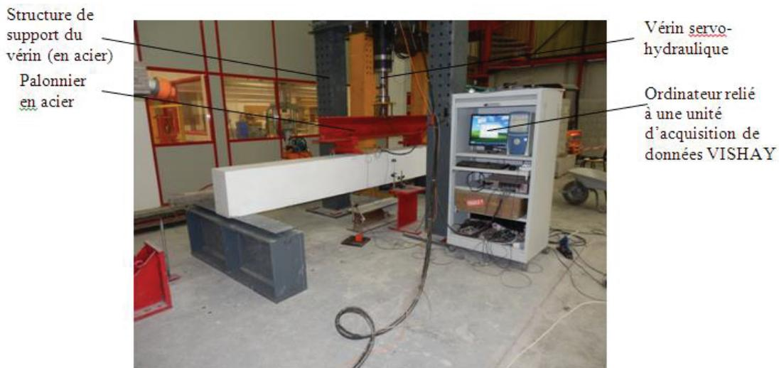
**Figure 4.3** - Dispositif expérimental de flexion 4-points
