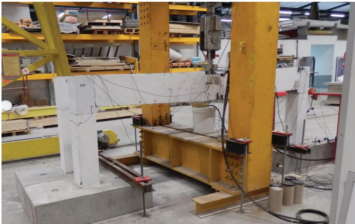
**Figure 7.17** – Dispositif d'essai des portiques
