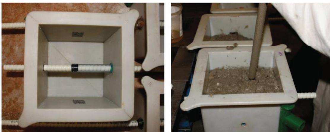
**Figure 2.** – (a) Préparation des moules (b) Piquetage du béton
