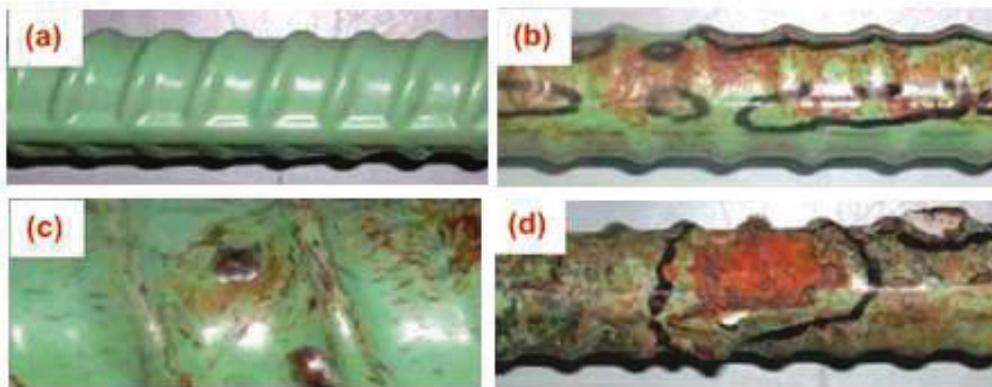
**Figure 2.2** - Observations sur des armatures acier recouvertes d'époxy extraites de dalles, (a) barre intacte, (b) revêtement fêlé, (c) revêtement fêlé et boursoufflés, (d) revêtement délaminé révélant une armature sévèrement corrodée
