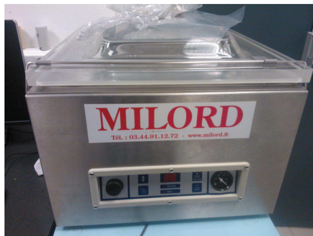
FIGURE 2.4 – Dispositif de mise sous vide partiel, pour conservation d'échantillon en sac étanche (pour l'essai couplé).
