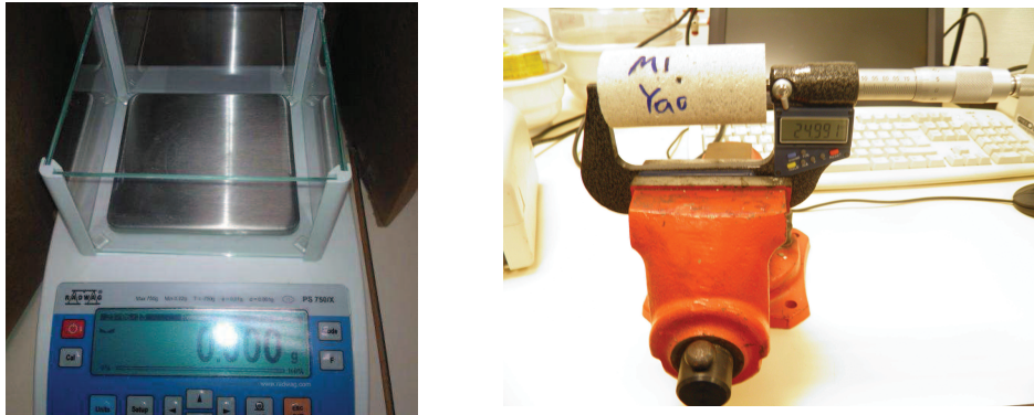
FIGURE 2.3 – Appareillages expérimentaux de (a) pesée (Balance) et (b) mesure de longueur (Palmer).
