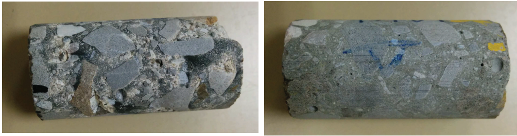
FIGURE 3.17 – Photographies d'échantillons cylindriques de béton de dimensions D20H40, illustrant les variations de leur volume disponible à la dé-saturation : (a) présence de pores millimétriques de béton CEM I, ou (b) homogénéité visible en surface de béton CEM V.
