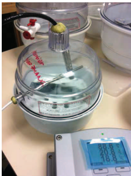
FIGURE 3.4 – Capteurs d’humidité relative Vaisala HMT337 et capteur USB placés en cloche à HR donnée, pour la mesure de HR et T à conditions de stockage de la cloche données.
