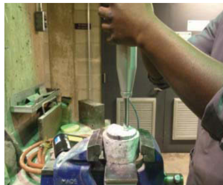
Essai réalisé sur la surface du joint pour déterminer le JCS des joints altérés
