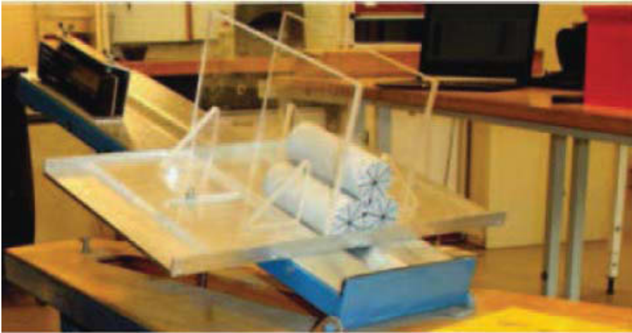
Figure 8: Essai de basculement (tilt test) pour mesurer \phi_b sur des surfaces de génératrices de trois échantillons de carottes cylindriques d'après Ruiz et al. (2014)
