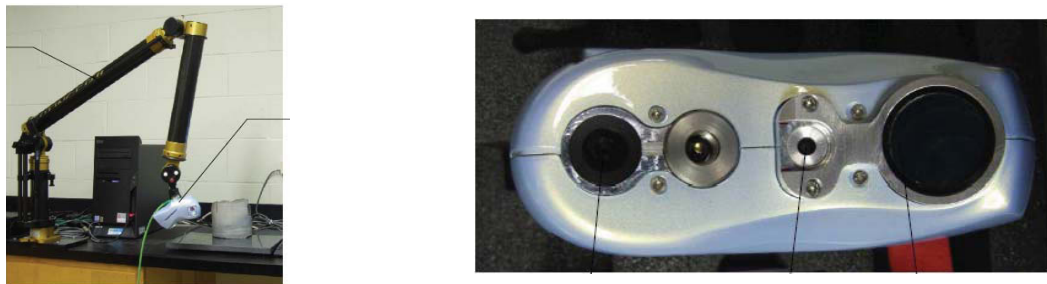
Figure 23: Profilomètre laser de l'Université de Sherbrooke: modèle Kréon Zéphyr 25 : ensemble du dispositif de mesure (à droite) et camera de mesure (à gauche) (Rousseau 2010)
