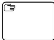
Figure 4.18 : Illustration d'une Tâche de type « Manuelle »
