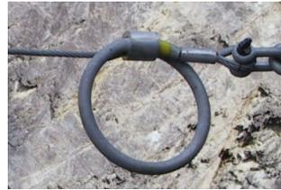
**FIGURE 2.16** – Le dissipateur d'énergie par frottement en forme d'anneau [50]
