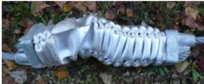
**FIGURE 2.45** – Le dissipateur d'énergie par flambement d'un tube métallique [49]
