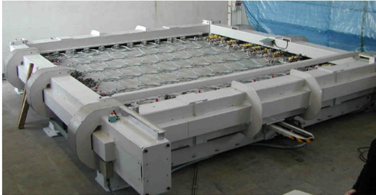
**FIGURE 2.53** – Le banc d'essai pour filets [33]
