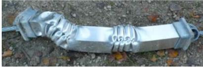
**FIGURE 2.15** – Le dissipateur d'énergie par flambement d'un tube en Aluminium [49]
