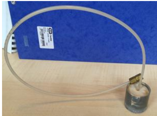
Figure II - 70 : Test de l'étanchéité du ciment prompt
