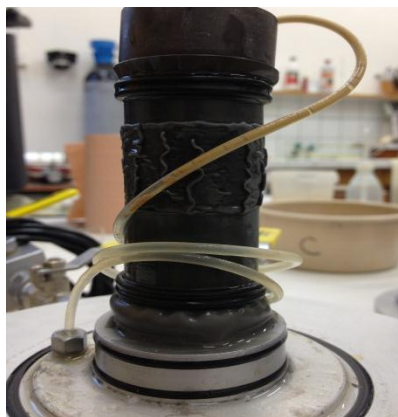
Figure IV - 29 : Drainage de la pâte dans le circuit d'air pour l'essai non-drainé
