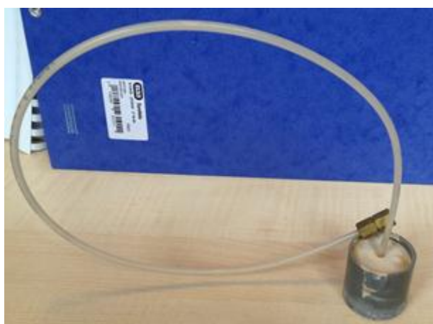
Figure II - 70 : Test de l'étanchéité du ciment prompt
