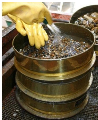
Figure I - 5 : Appareil expérimental pour tamisage humide (source internet)
