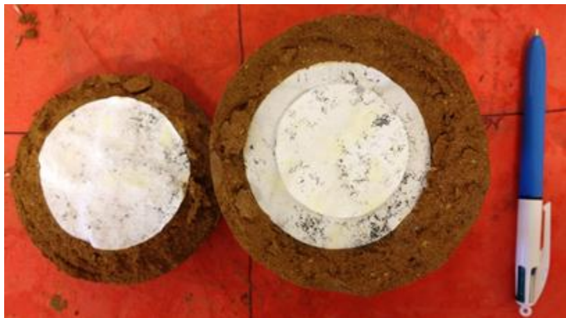
Figure II - 50 : La moisissure apparaît pendant l'équilibre du papier filtre et de l'échantillon
