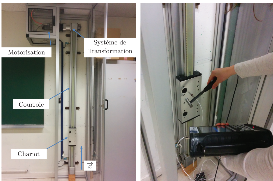
FIGURE II.11 – Système un axe à courroie et identification des modes propres
