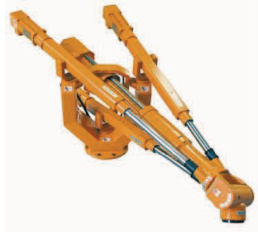
(b) Le Tricept et son système de contrôle de la position de l'effecteur [PKM12]
