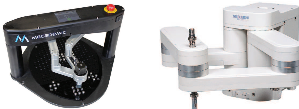
FIGURE IV.2 – Deux exemples de mécanismes 5 barres, pour la recherche (à gauche, le DexTAR de Mecademic [INC14]) et pour l'industrie (à droite, le Scara série RP de Mitsubishi Electric [COR14])
