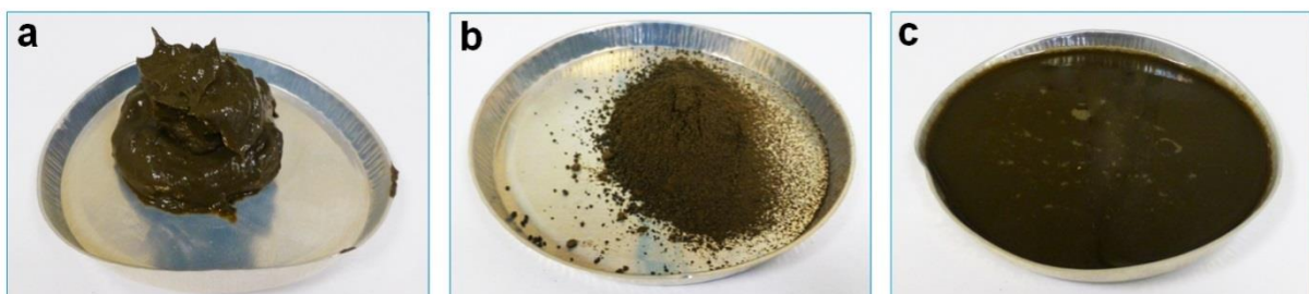
Figure 4-42 Boue structurée (a), boue séchée (b), boue réhydratée non-structurée (c). Les échantillons a et c ont une siccité de 14%.
