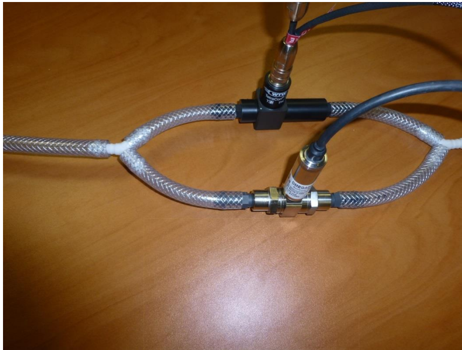
Figure 5-21 Capteurs du banc de mesure en continu (électrode pour les mesures électriques et capteur de pression).
