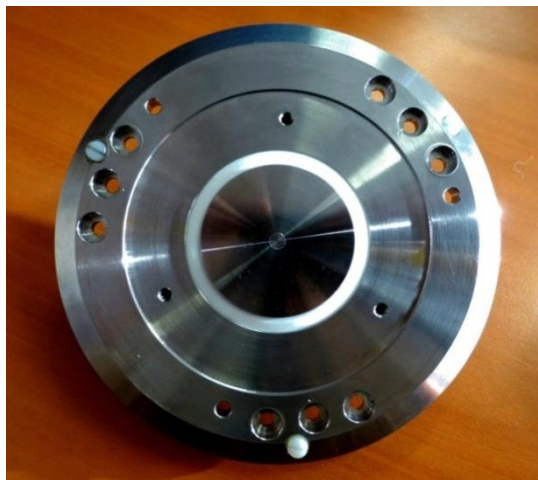
Figure 5-12 Photo de l'électrode conçue pour être adaptée à un rhéomètre de type MCR.
