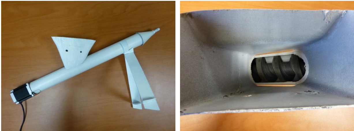
Figure 5-20 Système d'alimentation en boue, avec une vis sans fin, pour le banc de mesure en continu.
