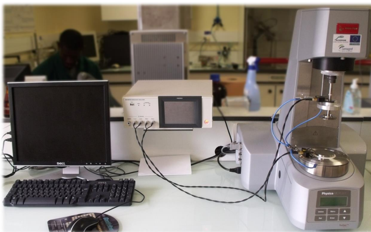
Figure 5-1 Système d'acquisition simultané rhéologie/électrique. De droite à gauche : le rhéomètre et sa cellule diélectrique, l'analyseur d'impédance, et l'ordinateur permettant la synchronisation.
