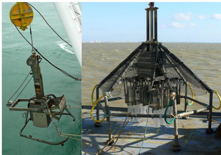
Fig.2.5 Left side : box-corer ; Right side : multi-tube corer
