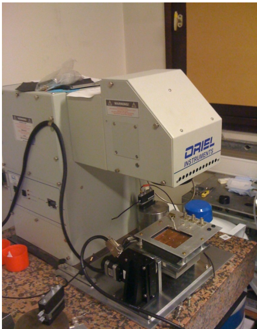
Fig.5.7. Photographie du banc expérimental avec la platine tournante sous le simulateur solaire
