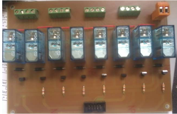
Fig.6.22. Carte relais, fabriquée au LGEP, pour commuter sur chacun des modules PV, en utilisant une seule charge variable La plateforme a été opérationnelle entre le 02/09/2013 et le 09/10/2013.
