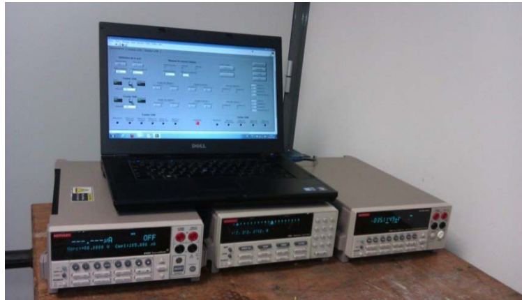
Fig.5.23. Photographie des appareils de mesures et de commutation de la plateforme tracker
