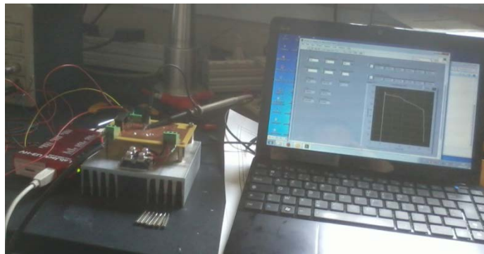
Fig.5.4. Photo du prototype de l'analyseur de modules PV
