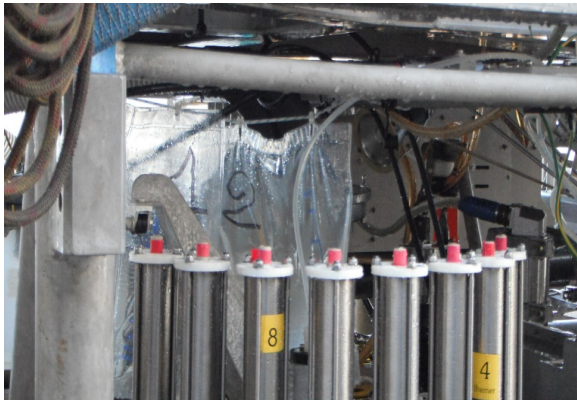
Figure 43 : Image des bouteilles PEP portées par le ROV VICTOR 6000 GENAVIR/IFREMER pour l'échantillonnage d'eau de mer dans la mission BOBECO. En plus des bouteilles argentées PEP, le site de pilotage de purge d'eau de mer comprend également deux sacs en plastique de 5 l chacun, utilisés dans des expériences de biodiversité microbienne.
