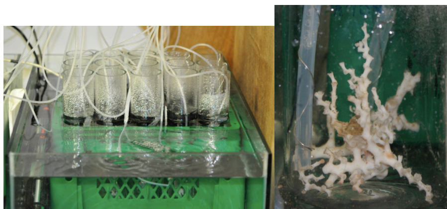
Figure 54 : Culture des coraux profonds Madrepora oculata et Lophelia pertusa utilisés pour la calibration de \delta^{11}\text{B} en fonction du pH de l'eau de mer. A gauche, le dispositif dans l'aquarium avec les différents tubes contenant chacun un échantillon. A droite, échantillon de Madrepora oculata dans son tube. Le capillaire argenté est la source de \text{CO}_2 utilisée pour le maintien de l'acidité de l'eau (Photographies : Berzunza Sanchez, 2011).
