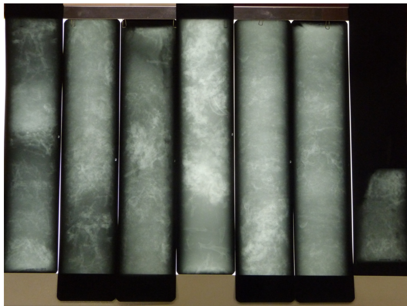
Figure 142: Image de la radiographie de la carotte sédimentaire Decors 27. Photo P. Montagna (CNR-ISMAR).
