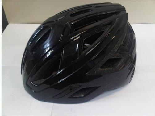
**Figure 69. Echantillon soumis au test d'impact normatif**
