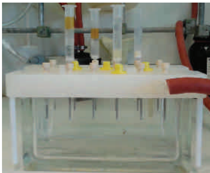
Image 3: Filtration des solvants avec un extracteur sous vide
