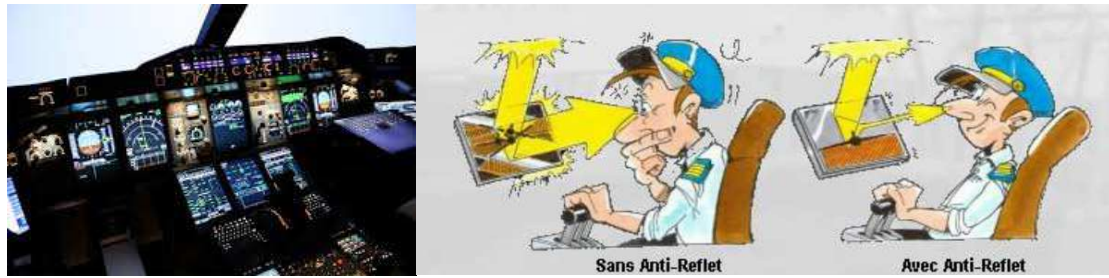
Figure Intro.1. Photographie du tableau de bord d'un Airbus A380 et illustration de réflexions lumineuses à la surface d'un affichage lumineux.
