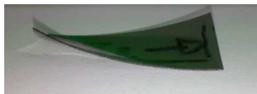
Figure II.37. Photographie d'un polariseur soumis aux vapeurs d'ammoniaque.
