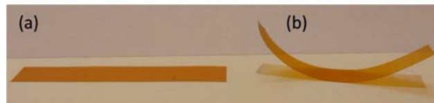
Figure IV.1. Photographie d'un film S^D déposé sur substrat de Kapton (a) avant et (b) après traitement thermique à 350^\circ\text{C} pendant 10 min.
