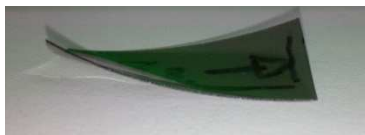
Figure II.37. Photographie d'un polariseur soumis aux vapeurs d'ammoniaque.
