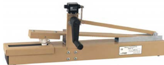
Figure A.3. Photographie d'un Crockmeter.
