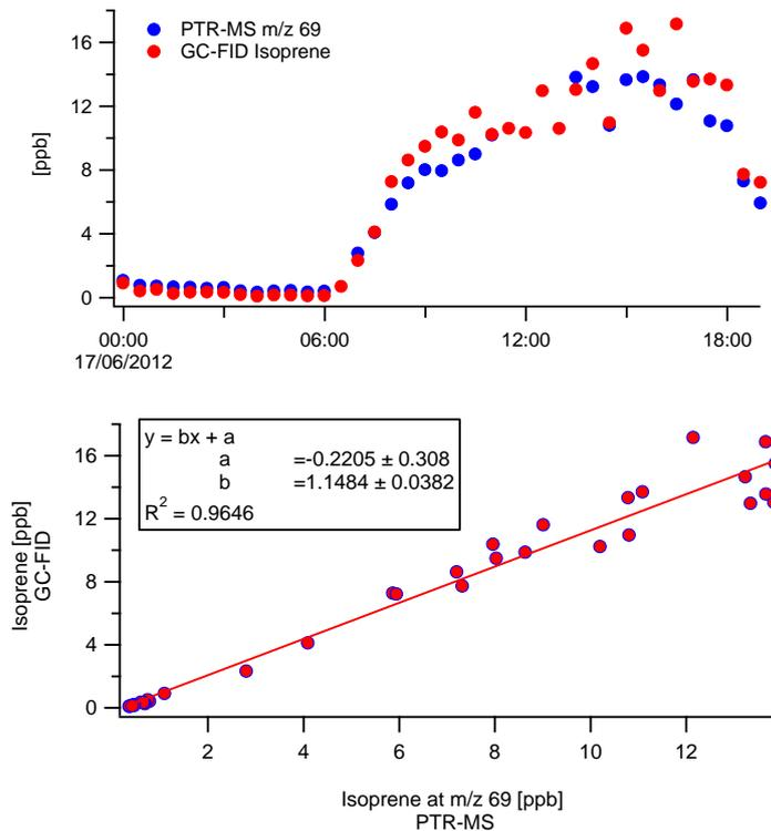
**FIGURE 2.17** (Haut) Séries de données de l’isoprène mesuré simultanément par le PTR-MS et la GC-FID, le 17/06/2012 à 10 m au-dessus du sol. (Bas). Droite de régression entre les mesures GC-FID et PTR-MS.
