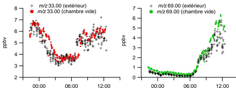
**FIGURE 2.22** Séries temporelles des concentrations d'isoprène ( $m/z$  69.00) et méthanol ( $m/z$  33.00) mesurés alternativement par PTR-MS à l'intérieur d'une chambre dynamique vide (sans biomasse) et dans l'air ambiant.
