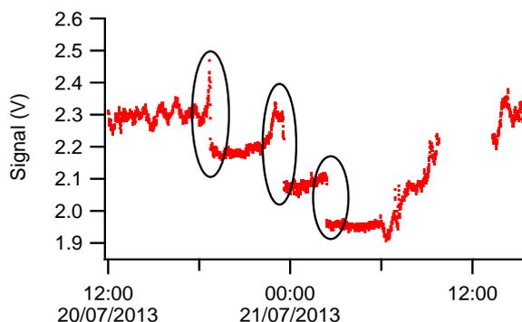
FIGURE 2.29 Signal brut du formaldéhyde pendant la période du 20 au 22 juillet. Les « sauts » observés correspondent probablement à la formation de bulles dans les solutions des réactifs.
