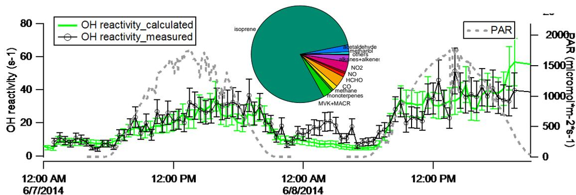
**FIGURE 5.8** Réactivité totale mesurée par la méthode CRM et réactivité totale calculée ( $\sum[\text{COV}]_i \times k_i$ ) à l'O<sub>3</sub>HP dans le cadre de CANOPEE 2. Le diagramme circulaire indique la contribution de chaque composé ou groupe de composés à la réactivité calculée à partir des mesures effectuées au-dessus de la canopée (source: thèse N.Zannoni, LSCE).
