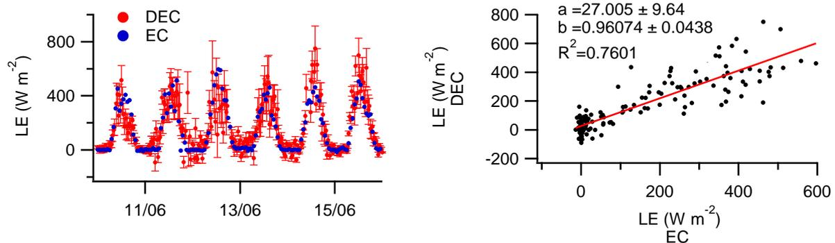
**FIGURE 2.20** (Gauche) Séries de données de flux de chaleur latente mesurés par la méthode DEC (couplage PTR-MS – anémomètre) et par la méthode de référence (couplage IRGA- anémomètre). (Droite) Régression linéaire entre les flux de vapeur d’eau mesurés par les deux méthodes.
