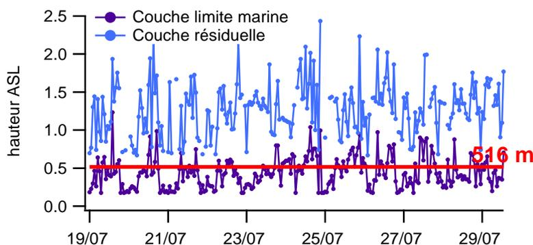
FIGURE 4. 6 . Hauteur des couches atmosphériques représentées par les transitions dans le contenu en aérosols (ASL : km above sea level). Résultats des données du LIDAR situé à Bastia. (Source : Jean-Leon, Laboratoire d'Aérologie).
