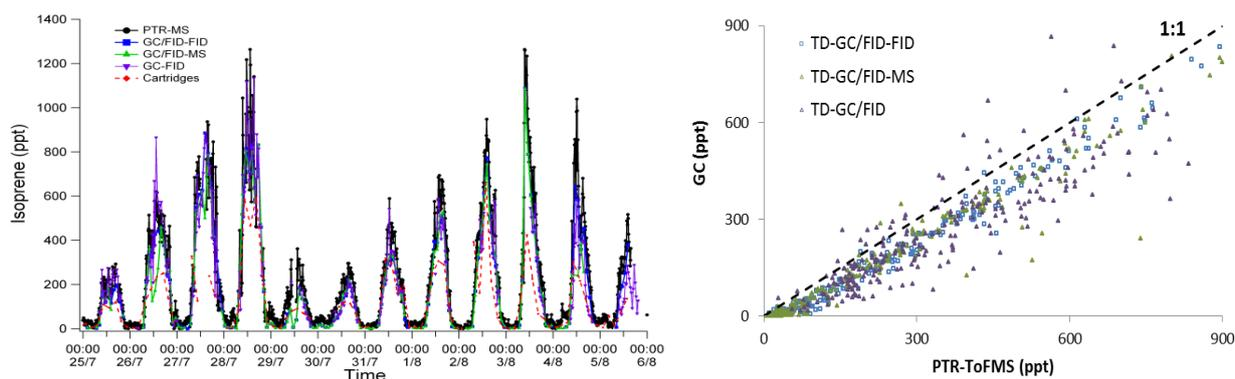
**FIGURE 2.30** Intercomparaison de trois chromatographies gazeuses et du PTR-tof-MS pour la mesure d'isoprène. (Gauche) Séries temporelles (Droite) Droite de régression GC vs PTR-tof-MS (Source : Ecole des Mines de Douai)
