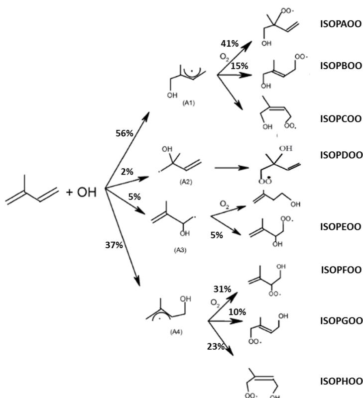
FIGURE 1.5 Premières étapes du mécanisme réactionnel Isoprène + OH
