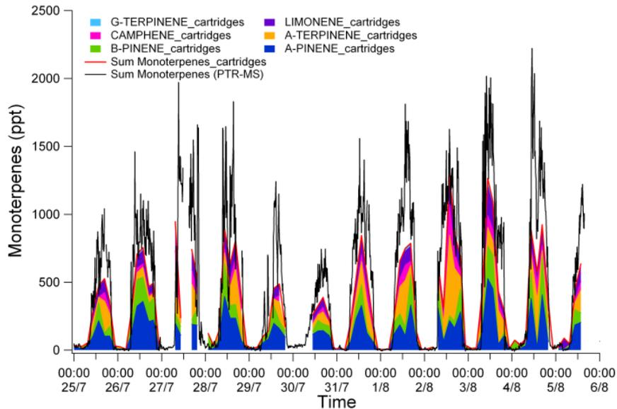
**FIGURE 2.31** Séries temporelles des mesures des différentes espèces de la famille des monoterpènes mesurés par prélèvement sur cartouches puis analyse GC-MS en différé. Somme des monoterpènes mesurés par PTR-MS.
