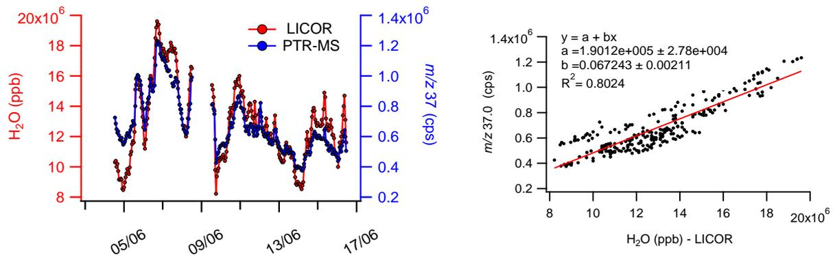
FIGURE 2.19 (Gauche) Séries de données de la masse  $m/z$  37 enregistré par le PTR-MS et de la concentration en vapeur d'eau enregistrée par l'IRGA. (Droite). Droite de régression linéaire entre la masse  $m/z$  37 et la concentration en vapeur d'eau.
