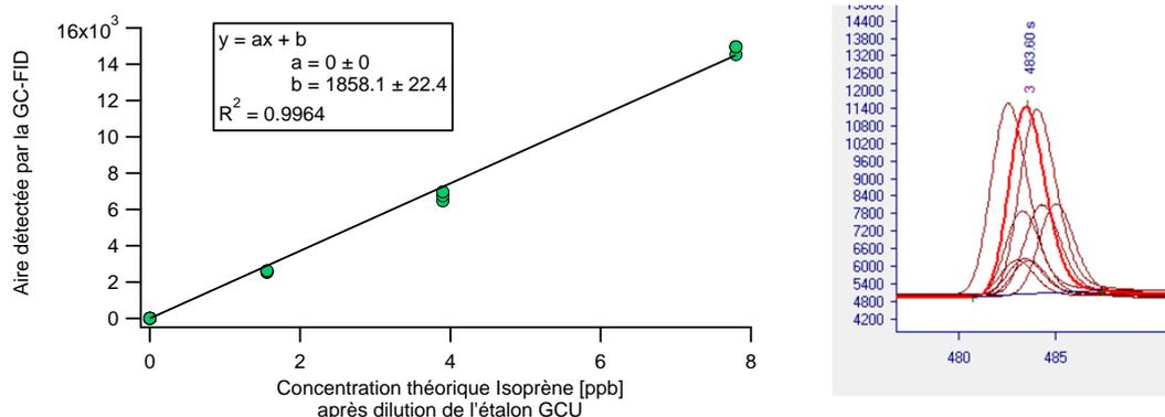
FIGURE 2. 11 Résultats de la calibration multipoints de la GC-FID à partir d'un étalon d'isoprène. (gauche) Droite d'étalonnage de la GC-FID pour la mesure d'isoprène (droite) Pics d'isoprène obtenus lors de la calibration multipoints
