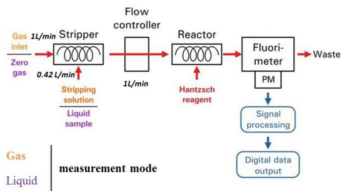
FIGURE 2.6 Circuit de l'échantillon gazeux ou liquide pour la mesure de formaldéhyde (Source : Aero-Laser GmbH)
