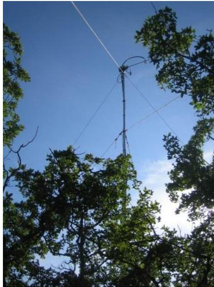
**FIGURE 2.24** Photographie du montage pour la mesure des flux de COVB. Mât de 10m, situé au cœur d'une forêt de chêne blanc (O<sub>3</sub>HP : Oak Observatory à l'Observatoire de Haute Provence), sur lequel étaient fixés les lignes de prélèvement de l'air ainsi que l'anémomètre sonic pour la mesure du vent.
