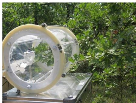
**FIGURE 2.21** Chambre dynamique en Téflon utilisée pour la mesure des taux d’émission de COVB à l’Observatoire du chêne pubescent (O<sub>3</sub>HP) de l’Observatoire de Haute Provence.
