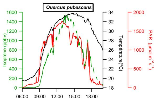
**FIGURE 3.2** Concentrations en isoprène mesurées par PTR-MS en sortie d'une chambre dynamique enfermant une branche de chêne blanc. Lumière et rayonnement photosynthétique enregistrés à l'intérieur de la chambre.
