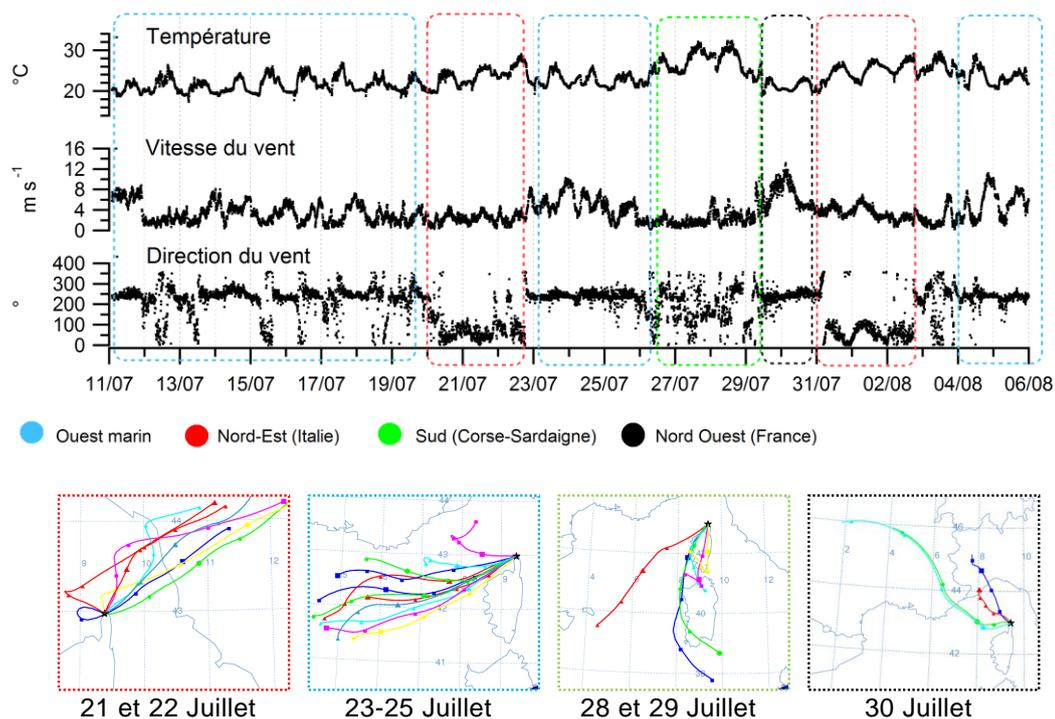
**FIGURE 4. 5** *Haut* : Température, vitesse et direction des vents enregistrés à 4 m au-dessus du sol, sur la station d'Ersa. *Bas* : Retro-trajectoires issues du modèle NOAA HYSPLIT MODEL- Durée des trajectoires : 24 heures. 1 trajectoire/6h.
