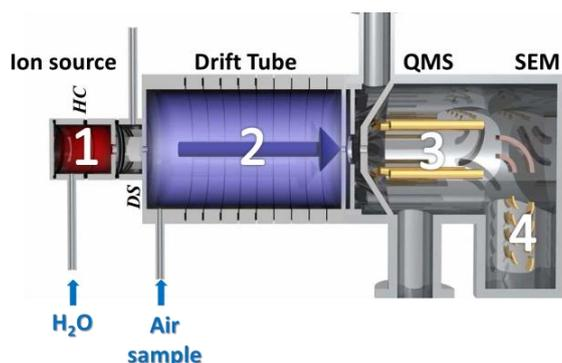
FIGURE 2.1. Représentation schématique du PTR-MS (source © Ionicon Analytic)
