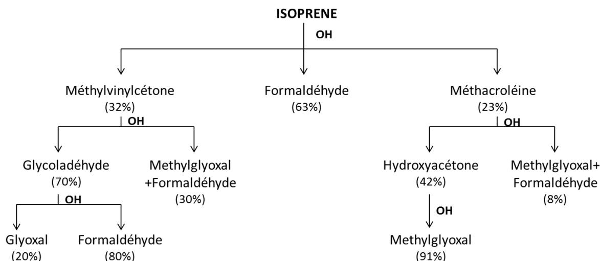
**FIGURE 1.4** Schéma de l'oxydation de l'isoprène par le radical OH. (Les nombres entre parenthèses correspondent aux rendements de production des composés secondaires en conditions de  $\text{NO}_x$  élevés) (Spaulding et al., 2003).
