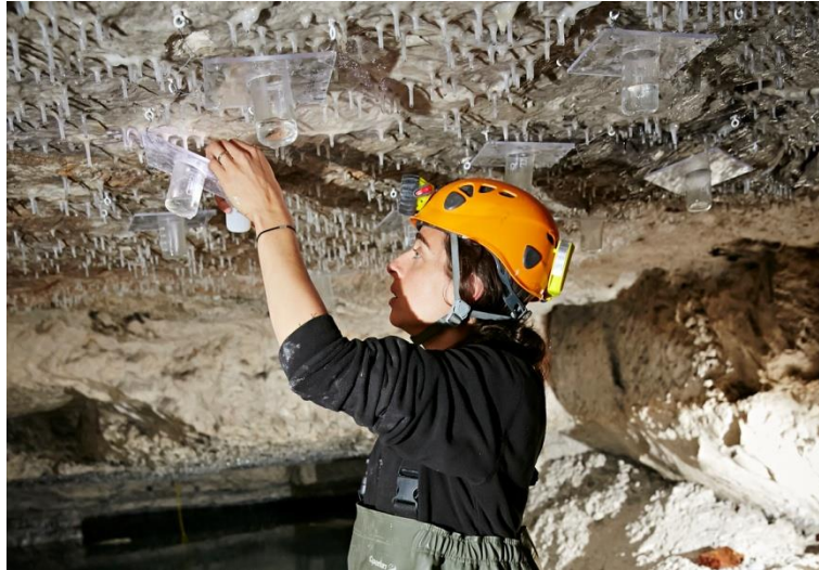
Figure 8-3 : Photographie du dispositif d'étude de l'hétérogénéité des flux de percolation.
