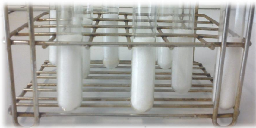
Figure 5-5 : Tubes à essais remplis de xylitol avant fusion dans le bain thermostaté
