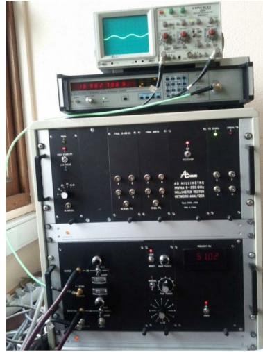
FIGURE 7.12 – Analyseur de réseaux vectoriel associé au banc de mesure AB millimètre.
