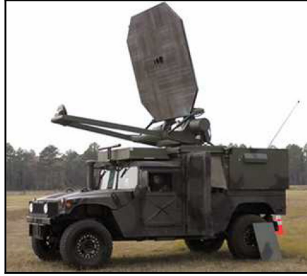
FIGURE 2.7 – Systèmes de dispersion de la foule (ADS) montés sur véhicule blindée léger, Hummer.
