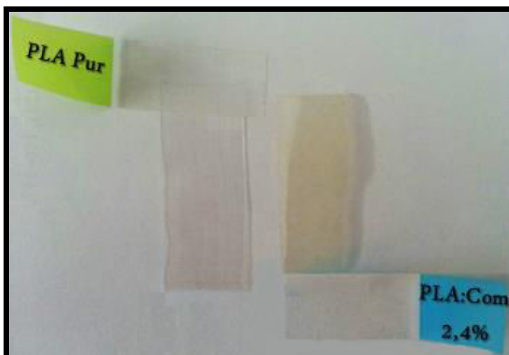
Figure 62: Films de PLA Pur et de PLA:Com-2,4% obtenus par extrusion
