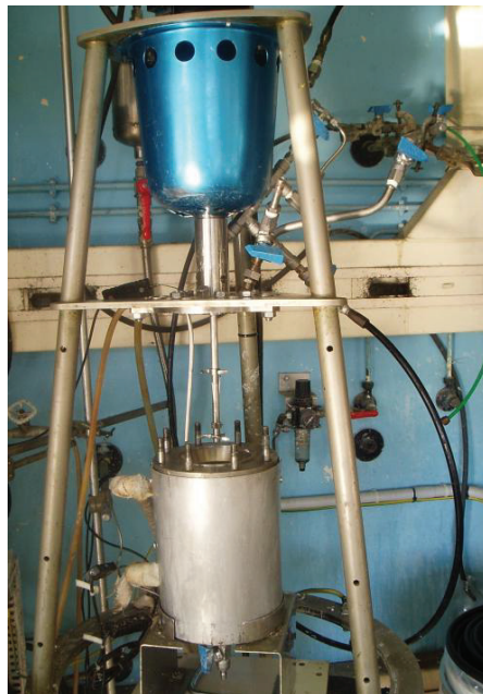
Figure 4-2 : Photographie du réacteur industriel utilisé au GRL – Arkema.
