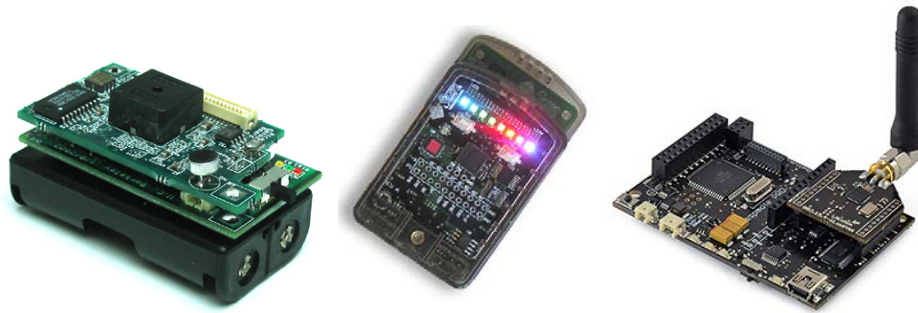
FIGURE 2.3 – Exemples de capteurs sans fil.
