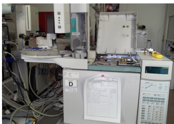
Figure 36: Photo du GC/MS Agilent Modèle 7890 (BAYALA Bagora, 2011)
