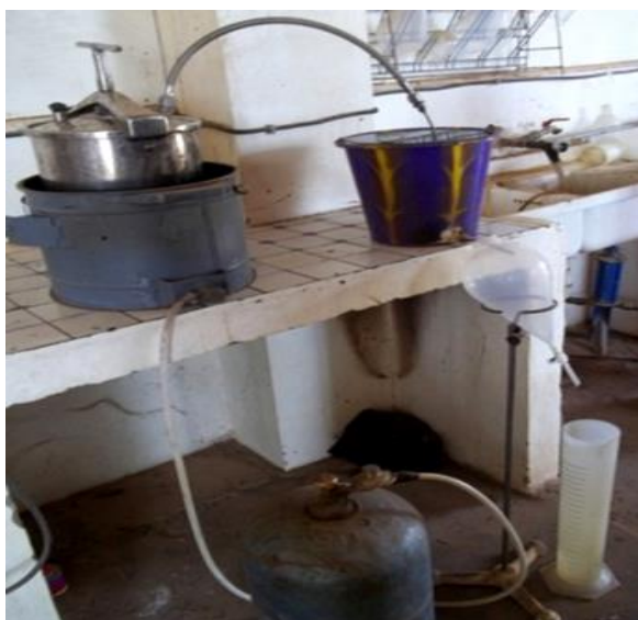
Figure 34: Photo du montage utilisé pour l'extraction des huiles essentielles (BAYALA Bagora, 2011)
