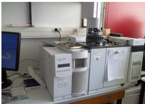
Figure 35: Photo du GC/FID Agilent Modèle 6890 (BAYALA Bagora, 2011)
