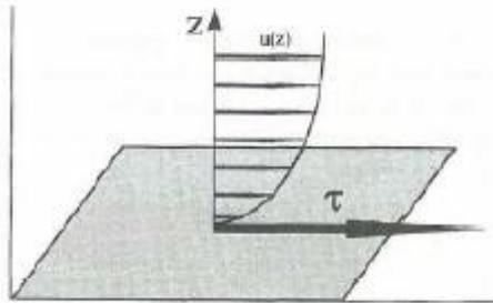
*Figure 1.15 Représentation de l'effet du sol sur l'écoulement de l'air et de la contrainte tangentielle  $\tau$  exercée par l'écoulement sur le sol (Alfaro, 1997). Le profil du vent est représenté par la quantité  $u(z)$ , composante horizontale de la vitesse du vent, qui est fonction de  $z$*
