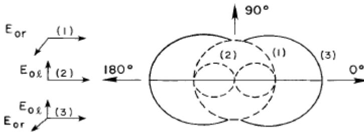
*Figure 2. 7 : Diagramme polaire de l'intensité diffusée pour les molécules de Rayleigh : (1) lumière incidente polarisée avec un vecteur champ électrique perpendiculaire au plan de la figure, (2) lumière incidente polarisée avec un vecteur champ électrique dans le plan de la figure et (3) lumière incidente non polarisée.*
