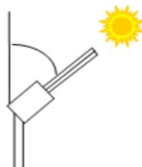
Les premières mesures se font en visant directement le soleil. Les mesures sont alors des mesures d'extinction solaire qui permettent de déduire les épaisseurs optiques des aérosols.
