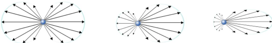
Figure 2. 2 De gauche à droite : intensité de la diffusion Rayleigh, de la diffusion Mie pour de petites particules et de la diffusion Mie pour de grosses particules, en fonction de la direction. L'onde incidente arrive par la gauche.
