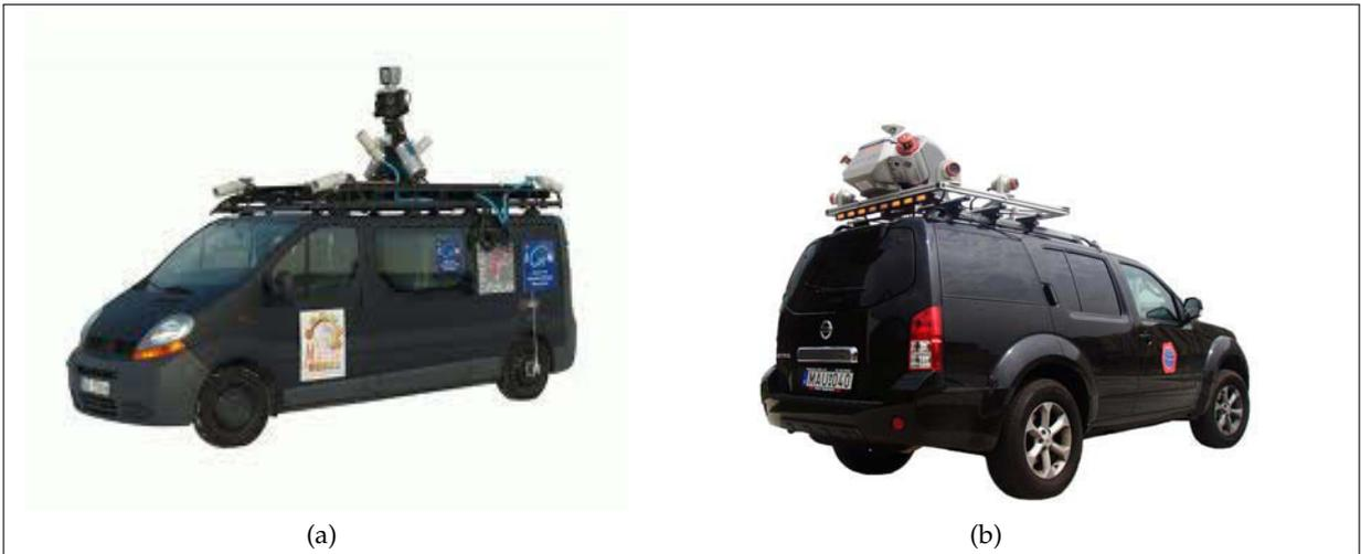
FIGURE 1 : Les véhicules numérisateurs terrestres (a) STÉRÉOPOLIS II (source [Ste14]) et (b) Vis center's VizTruck.
