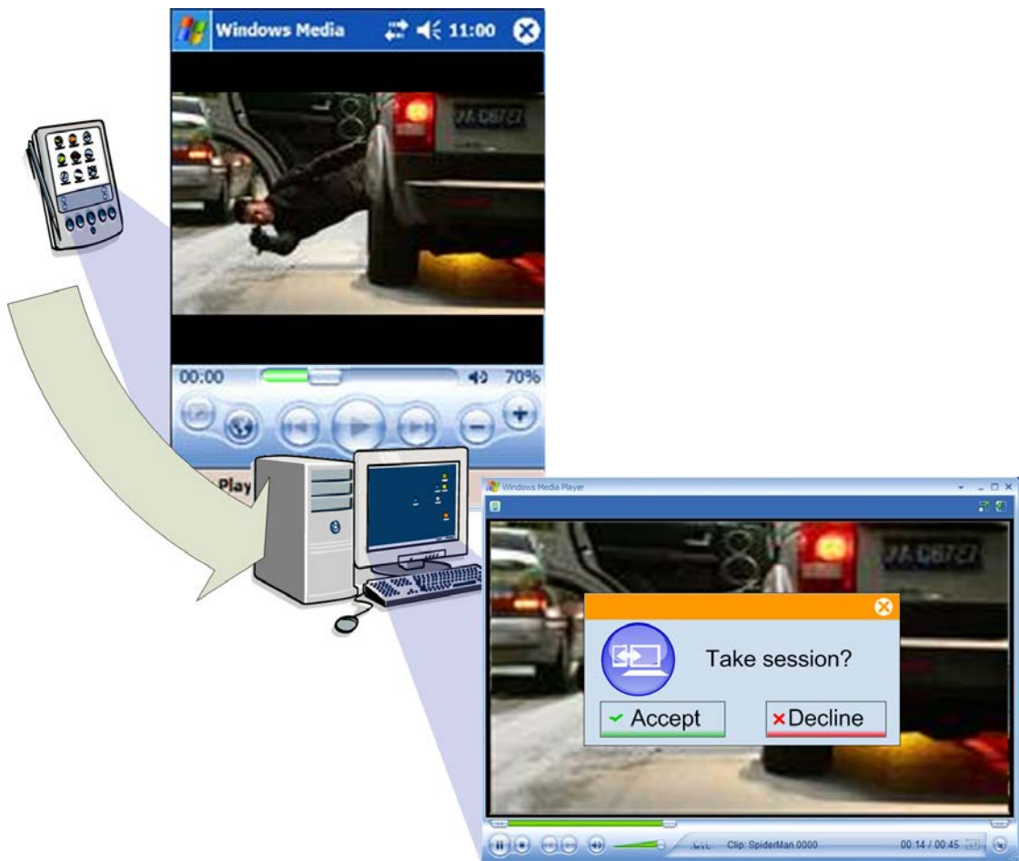
FIGURE 4.2 – Scénario de transfert de service multimédia.
