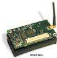
Figure 17: illustration d'un capteur MICA2
