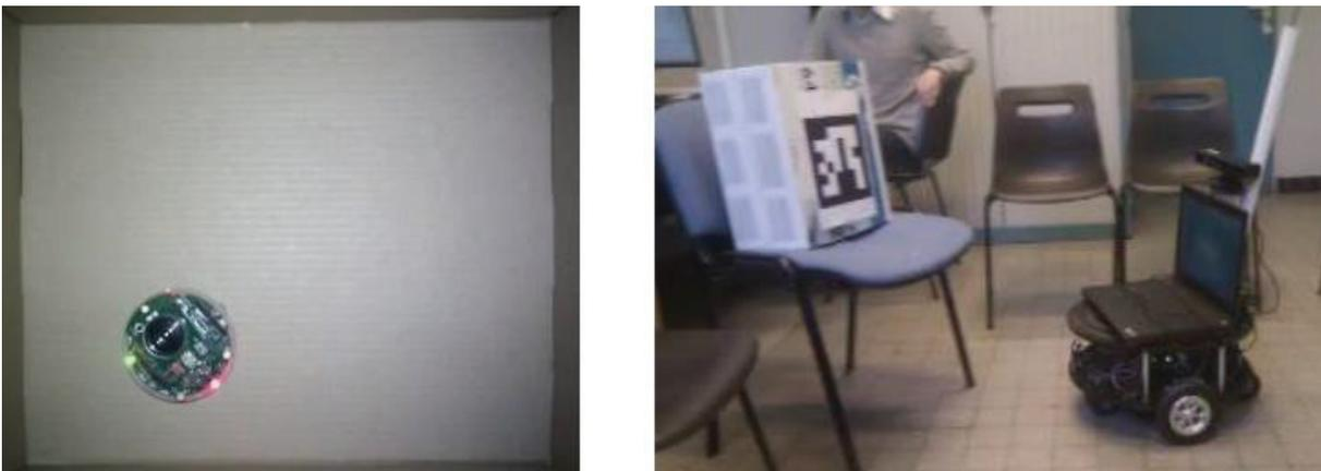
FIGURE 10.2 – Implémentation de nos mécanismes dans des robots. À gauche, le robot e-puck dans le *box world* [52]. L'implémentation a été réalisé avec Laurent Hu. À droite, le robot Eddie. La proie est représentée par un QR-code. L'implémentation a été réalisée par Christian Wolf et Martin Kodys, de l'équipe IMAGINE<sup>10</sup>.
