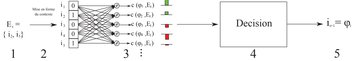
FIGURE 9.4 – Implémentation des signatures d’interactions. 1) l’agent expérimente le contexte E_t . Celui-ci est mis sous la forme d’un vecteur afin de pouvoir être utilisé par le réseau neuronal implémentant les signatures (2). Les signatures déterminent la certitude de chaque interaction \varphi \in \Phi (3). Ces certitudes sont utilisées par le système de décision (4) pour sélectionner l’interaction intention i_{t+1} du cycle suivant (5).
