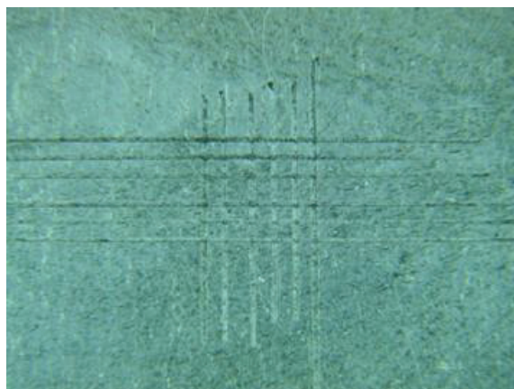
Figure 102 : Photographie d'un dépôt de NiP sur PA12 après le test au Scotch®. Le PA12 a été traité par plasma selon les conditions optimales avec le mélange NH_3/H_2 déterminées par le modèle polynomiale du second degré : densité de puissance = 72 W/dm^3 ; pression = 203 Pa ; proportion de NH_3 = 72\% et durée de traitement = 109 s .
