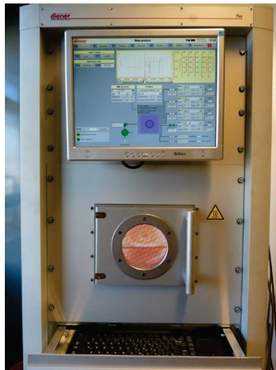
Figure 51 : Photographie du réacteur plasma micro-ondes Pico-UHP-MW-PC (Diener).
