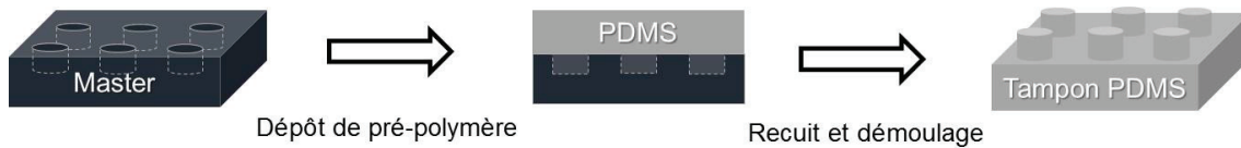
Figure 28 : Schéma montrant la fabrication d'un tampon en PDMS par Replica Molding.
