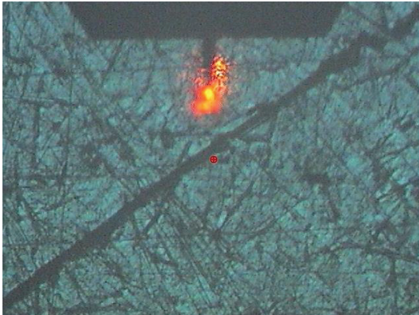
Figure 75 : Photographie prise par la caméra de l'AFM montrant la pointe placée au-dessus d'une surface dégraissée de PA12.
