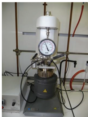
Figure 2. Autoclave Parr avec cuve de 300 mL utilisé pour cette étude
