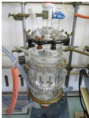
Figure 21. Réacteur double enveloppe équipé d'un agitateur mécanique utilisé pour produire du 1,2,3-triméthoxypropane à plus grande échelle
