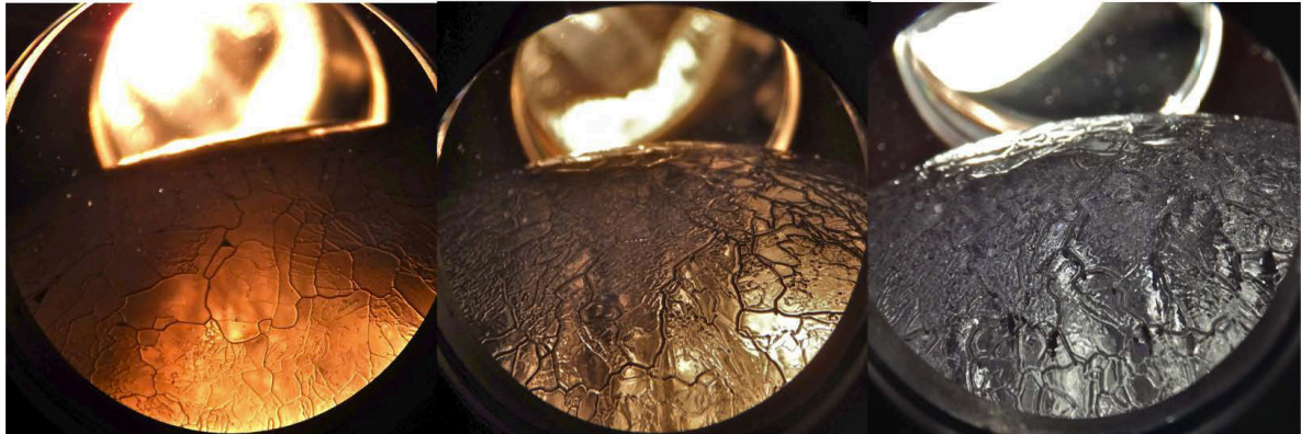
FIGURE 5.24 – Evolution de teinte du slab observé transversalement, lié à la sublimation par pompage. Image de gauche : juste avant la mise en route du pompage ; les deux suivantes : en pompage, à t_o+17h40 et t_o+1j+2h30 respectivement. L'éclairage par la lampe halogène vient de l'arrière plan ; les angles d'incidence et de vue varient légèrement d'une image à l'autre cependant aucun traitement particulier de la saturation n'est appliqué aux photographies qui montrent les effets de la perte de contact entre la glace des parois en cuivre.
