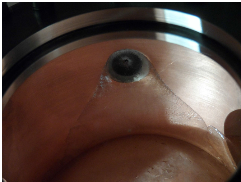
FIGURE 3.13 – Condensation à proximité de l'entrée due à un début de bouchage du tuyau d'arrivée du gaz.
