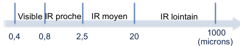
FIGURE 2.2 – Schéma des gammes spectrales visible et infrarouge selon la longueur d'onde.
