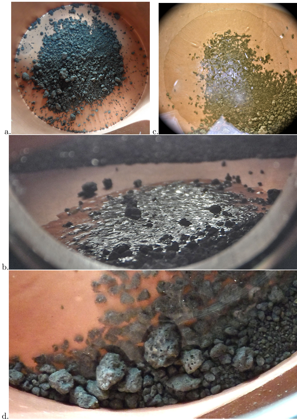
FIGURE 5.18 – Condensation de CO 2 sur minéraux. a : Grains grossiers de basalte placés dans la cellule; b : Progression verticale du slab autour des plus gros fragments; c : Slab en formation sur le basalte; d : Zoom sur la glace atteignant les grains de roche du bord, on distingue la légère dépression au contact du minéral de la surface de la glace en train de croître; (a et c : vu de dessus; b, d : vue latérale)
