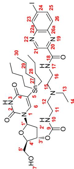
A une solution de **37** (90 mg, 0.17 mmol) dans le THF anhydre (3 mL) est ajouté sous argon le TBAF (1M dans le THF, 162  $\mu$ L, 0.16 mmol). Le mélange est agité à TA pendant 1 h 30 puis versé dans 30 mL de solution aqueuse saturée de  $\text{NaHCO}_3$ . La solution obtenue est extraite avec 3x8 mL de  $\text{CH}_2\text{Cl}_2$ . Les phases organiques sont combinées, séchées sur  $\text{MgSO}_4$  et le solvant est évaporé sous vide.
