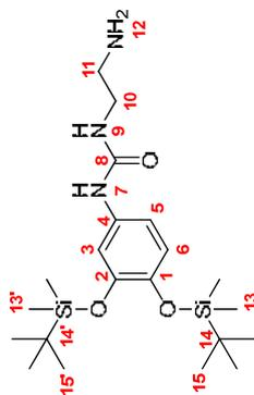
A une solution de **109** (1.240 g, 2.30 mmol) dans le CH<sub>2</sub>Cl<sub>2</sub> anhydre (25 mL) est ajouté sous argon le TFA (1.41 mL, 18.38 mmol). Le mélange est agité à TA pendant 4 h 30, puis versé dans 250 mL de solution aqueuse de Na<sub>2</sub>CO<sub>3</sub> à 5 %. La solution obtenue est extraite avec 3x150 mL d'AcOEt. Les phases organiques sont combinées et lavées avec 150 mL de solution aqueuse saturée de NaCl, séchées sur MgSO<sub>4</sub> et le solvant est évaporé sous vide.
